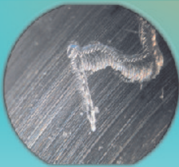
Foto 1. Die Oberfläche mit der absichtlich angebrachten Beschädigung (in der Form des Buchstabens "N").
