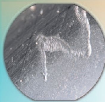
Foto 2. Nach 15 Minuten, der Wiederherstellungsvorgang an der Beschädigung ist deutlich sichtbar.
